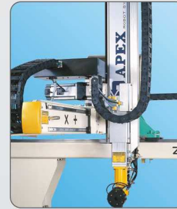
上下行之Y軸運動，採用高剛性的齒輪加齒排的機構。
