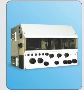
AC無炭剛式伺服馬達及獨立的驅動器控制系統，可三軸同動，定位精度可保持 \pm 0.1\text{mm} 以內。
